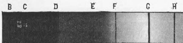
Spectre (positif) photographié sur plaque Lumière (étiquette bleue) (flamme d'acétylène, pose 17 secondes).
