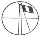
Schéma montrant la coïncidence ou la non-coïncidence des images dans le télémètre Barr et Stroud. La correction faite on prend la moyenne de dix lectures.
