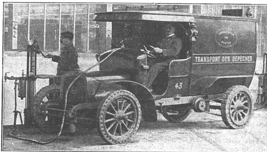
UNE VOITURE DES POSTES FAIT SON PLEIN D'ESSENCE AVEC L'APPAREIL « BOWSER » SANS DANGER D'INCENDIE, NI D'EXPLOSION, NI DE PERTE.
