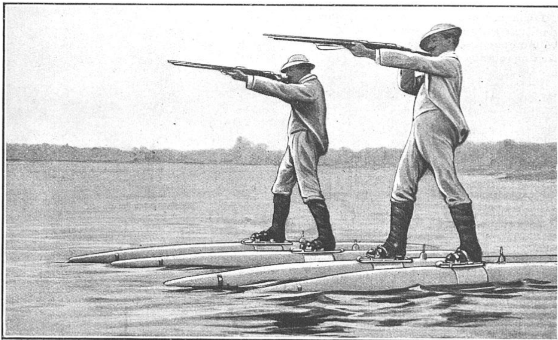
Le patin aquatique se plie rapidement et, sous un petit volume, est aisément transportable.
