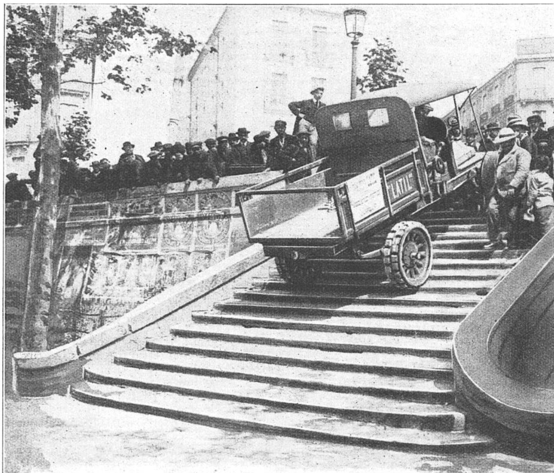
LES CAMIONS A ADHÉRENCE TOTALE PEUVENT GRAVIR UN ESCALIER SANS PATINER Le tracteur Blum-Latil, que représente cette photographie, muni d'un moteur de puissance moyenne (15 chevaux), a monté les marches d'un escalier près de la gare de Béziers.
