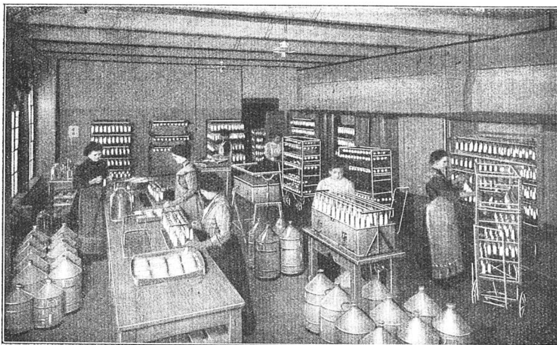
ATELIER DE COLLODIONNAGE MÉCANIQUE ET DE SÉCHAGE DES MANCHONS
