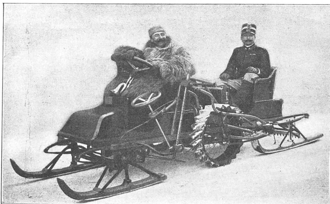
LE TRINEAU DU LIEUTENANT DE LA BESSE A BÉNÉFICIÉ DES PROGRÈS DE L'AUTOMOBILISME Le trineau est une véritable automobile dont les roues ordinaires, trop lisses pour mordre les surfaces unies de neige ou de glace, ont été remplacées par des roues motrices à jantes cannelées.
