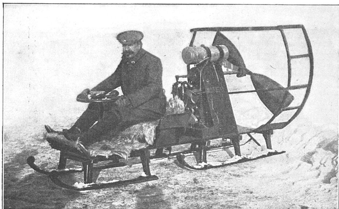
LE PROPULSEUR AÉRIEN FUT APPLIQUÉ AVEC SUCCÈS AU TRINEAU Ce système de propulsion ne présente aucune difficulté de montage. Il consiste simplement en un bâti supportant une hélice actionnée par un moteur de quelques chevaux.
