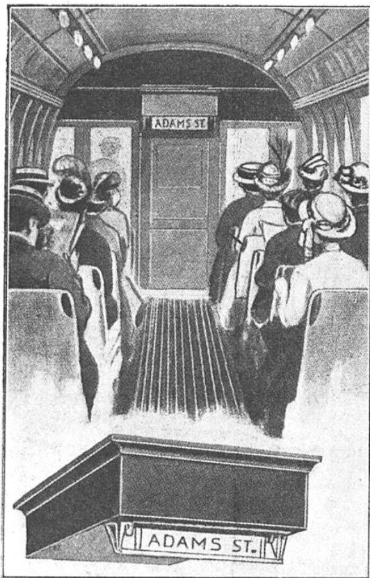
VOYAGEURS, APPRÊTEZ-VOUS A DESCENDRE Une compagnie américaine de tramways vient d'expérimenter avec succès un dispositif qui indique automatiquement aux voyageurs le nom de chacune des rues que croise le véhicule.
