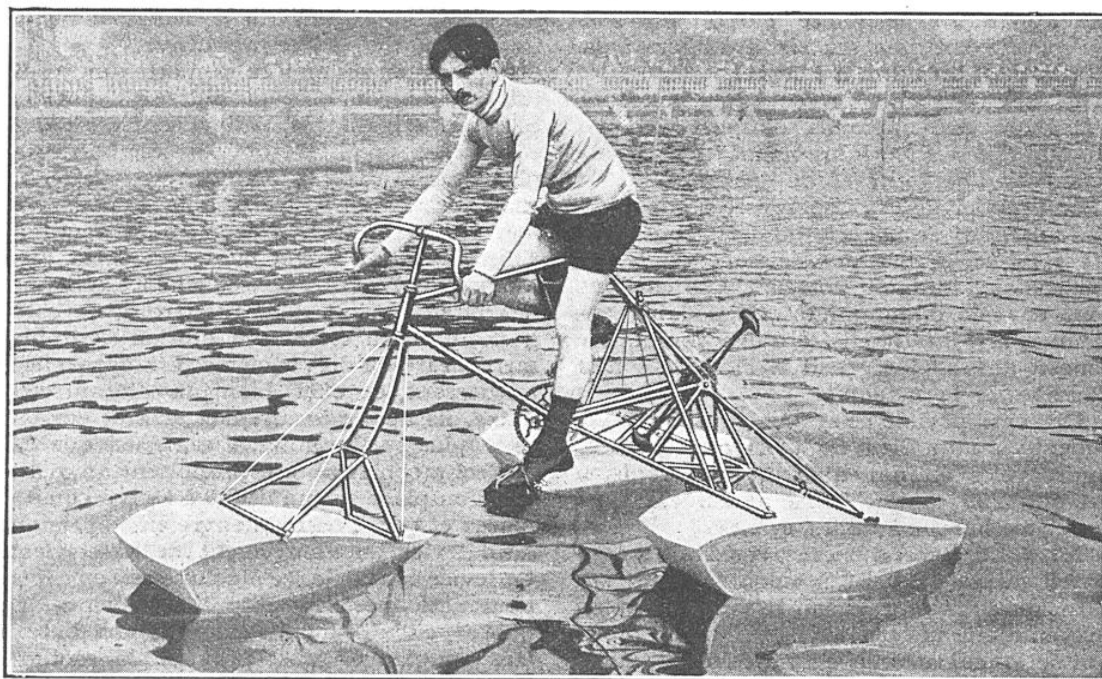
UN HYDROCYCLE QUI A DES FLOTTEURS D'HYDROAÉROPLANE
