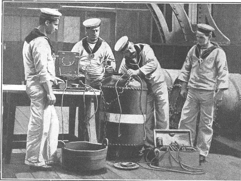
ÉPREUVE DU CIRCUIT ÉLECTRIQUE D'INFLAMMATION D'UNE MINE ÉLECTRO-MÉCANIQUE A BORD DU NAVIRE-ÉCOLE "VERNON", DE LA MARINE BRITANNIQUE
