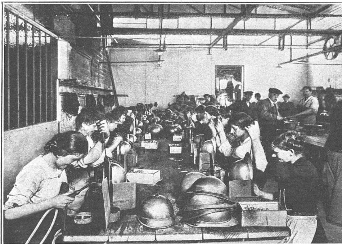
D'AUTRES OUVRIÈRES SOUDENT DES CRAMPONS À L'INTÉRIEUR DES CASQUES POUR FIXER LA JUGULAIRE ET LE TURBAN DE LA COIFFE
