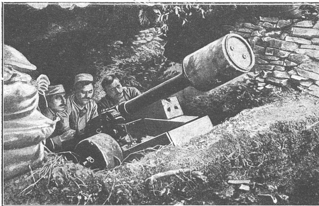
CANON DE MONTAGNE DE 80 MILLIMÈTRES LANÇANT UNE MINE AÉRIENNE DE 120 KILOGRAMMES
