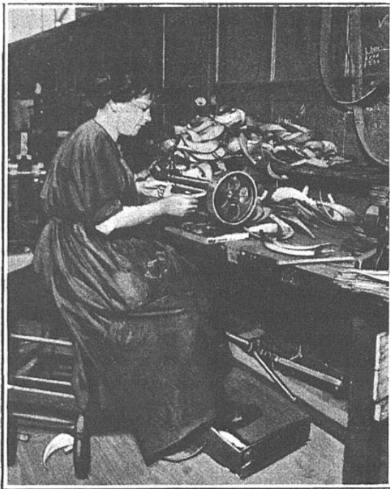
ON VOIT ICI UNE OUVRIÈRE PROCÉDANT A LA FABRICATION DES VISIÈRES ET DES COUVRE-NUQUE AU MOYEN D'UN LAMINOIR
