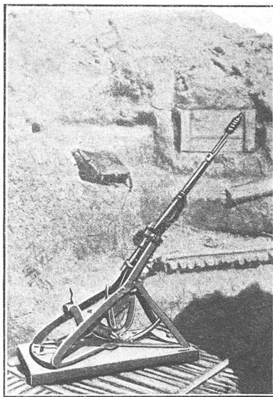
FUSIL DISPOSÉ SUR UN AFFUT SPÉCIAL POUR LE LANCEMENT DE LA GRENADE ALLEMANDE A TIGE MÉTALLIQUE
