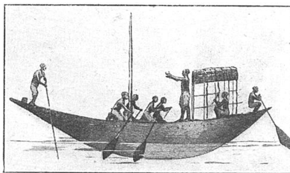
DANS LES TEMPS ANCIENS, UN AVIRON, PLACÉ À L'ARRIÈRE, JOUAIT LE RÔLE DE GOUVERNAIL
