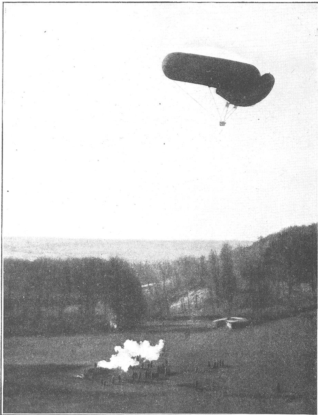
BALLON-CERF-VOLANT FRANÇAIS EN COURS D'ASCENSION, NON LOIN DU FRONT Le ballon s'élève de nos lignes, par vent faible, pour reconnaître les positions ennemies. Le nuage de fumée blanche que l'on voit au bas de la photographie est produit par le treuil à vapeur qui sert à dérouler et à enrouler le câble.
