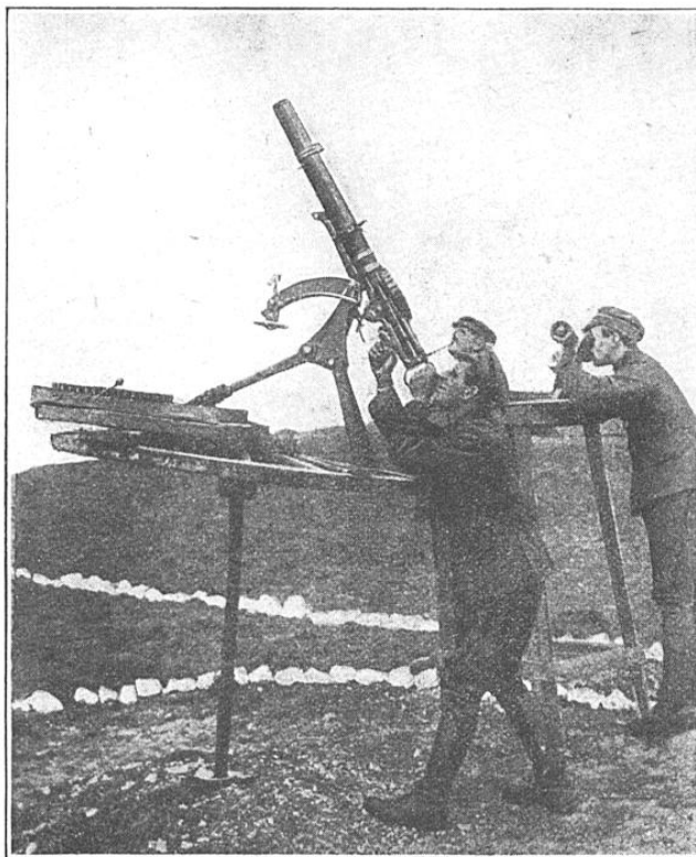
MITRAILLEUSE ANGLAISE LEWIS TIRANT CONTRE AVION Installation de fortune sur une roue de charrette tournant sur son essieu disposé verticalement. Derrière le mitrailleur se tient le télémètreur, chargé de lui indiquer les distances de tir.
