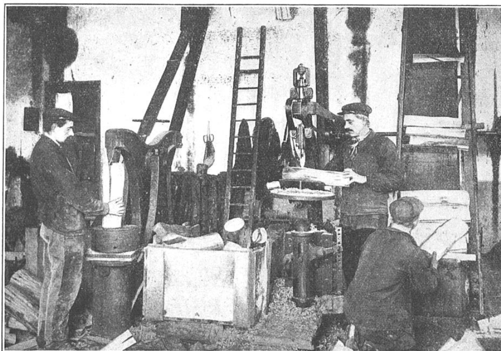
OPÉRATION DU PERÇAGE DES BUCHES POUR LA SUPPRESSION DES NŒUDS INTÉRIEURS
