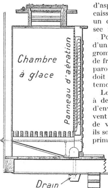
BAC A GLACE D'UN ANCIEN WAGON FRIGORIFIQUE
