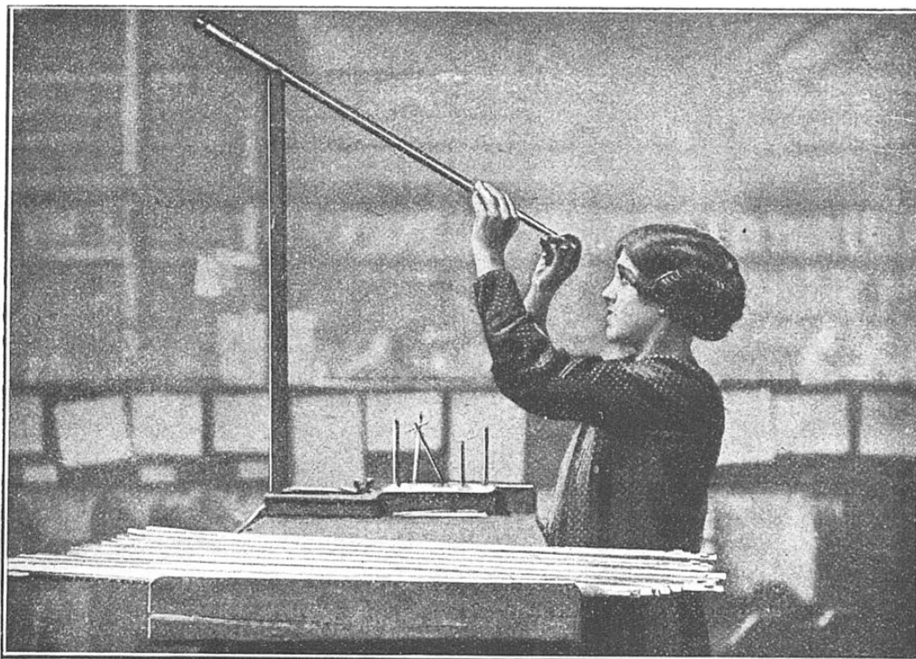
OUVRIÈRE EXAMINANT LES RAYURES D'UN CANON, DANS UNE MANUFACTURE FRANÇAISE
