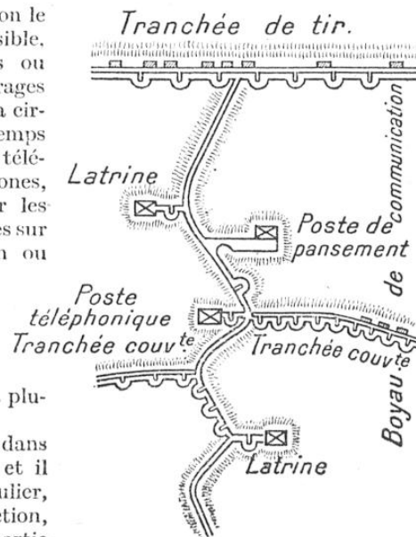
DISPOSITION D'UNE TRANCHÉE ALLEMANDE DE PREMIÈRE LIGNE
