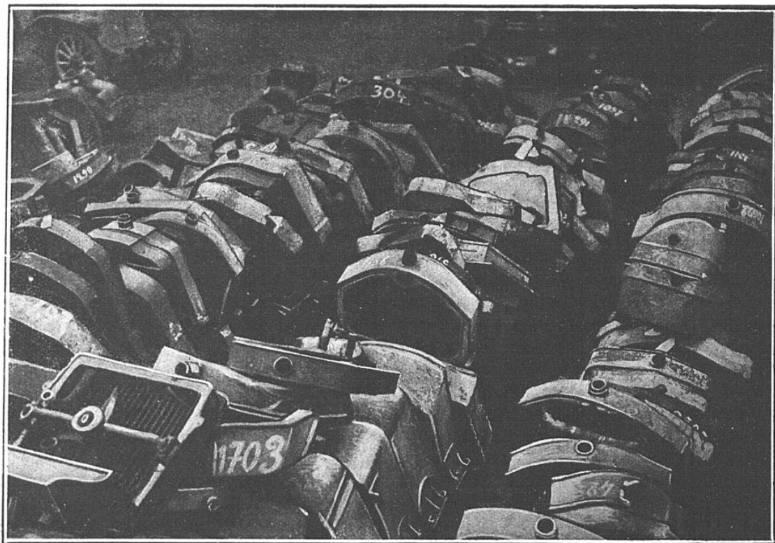
RADIATEURS DÉMONTÉS POUR ÊTRE EXAMINÉS EN VUE DE RÉPARATIONS POSSIBLES
