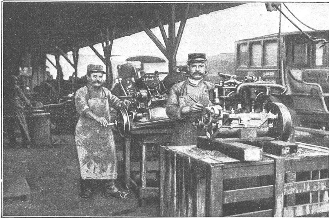
REMISE EN ÉTAT DES GROUPES MOTEURS D'AUTOS SOUS LES HANGARS DU PARC
