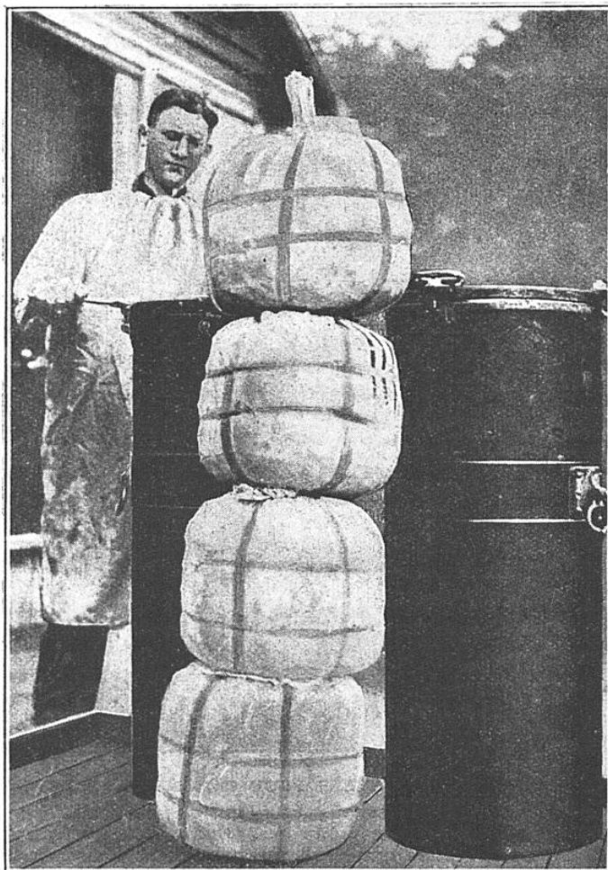
CES QUATRE SACS DE POUDRE NE CONSTITUENT QU'UNE SEULE CHARGE POUR LES CANONS DE 356 MILLIMÈTRES
