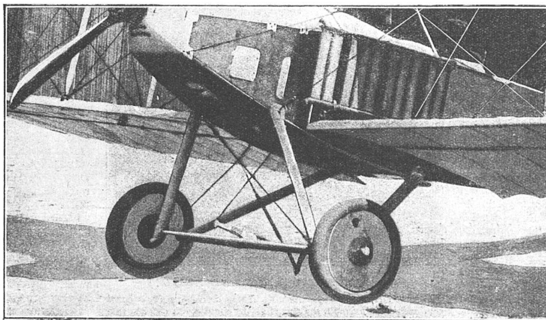
LES ROUES ET LE SOC D'ARRÊT DU CHASSIS DE L'APPAREIL « ALBATROS »
