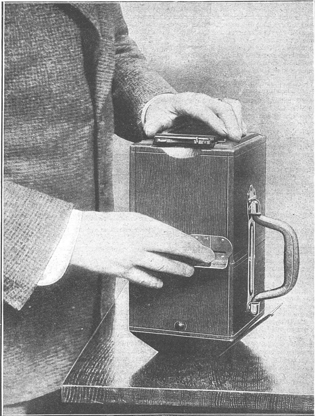
APPAREIL SPÉCIALEMENT CONÇU POUR PHOTOGRAPHIER LES EMPREINTES DIGITALES L'appareil est placé verticalement et de manière que la petite base de sa partie pyramidale recouvre exactement l'empreinte à photographier.
