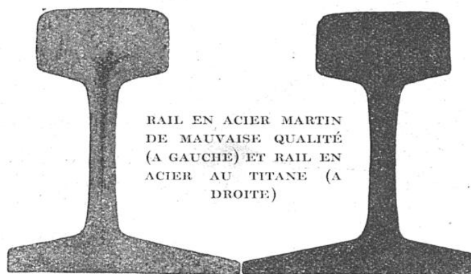
Ces deux coupes montrent que l'acier au titane présente une texture homogène, tandis que l'acier Martin mal fabriqué donne lieu à des soufflures intérieures qui diminuent considérablement la résistance du rail et peuvent même occasionner sa rupture.
