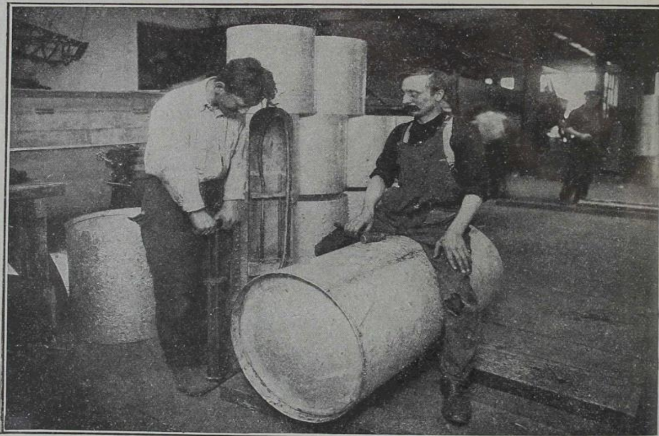
LA VÉRIFICATION DE L'ÉTANCHÉITÉ DES FLOTTEURS EN TOLE D'ACIER Le rivetage terminé, cette vérification s'opère au moyen d'eau sous pression.
