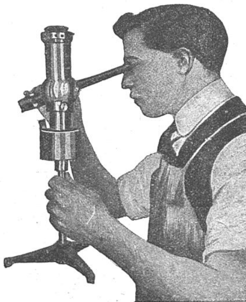
LUNETTE PYROMÉTRIQUE A MAIN ET A VISION DIRECTE POUR ATELIER
