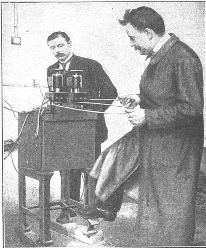
FIG. 4. — OUVRIER SOUDANT LES EXTRÉMITÉS DE LA JANTE D'UNE ROUE D'UNE VOITURE D'ENFANT
