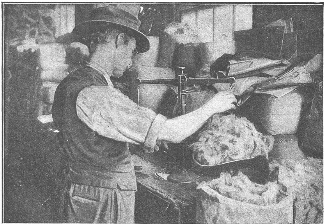
PUIS ON PROCÈDE SUR UNE BALANCE D'UNE GRANDE JUSTESSE A LA PESÉE DES POILS L'ouvrier pèse exactement la quantité de poils nécessaire pour chaque chapeau.
