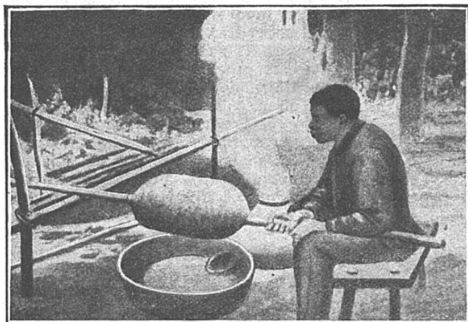
COAGULATION DU CAOUTCHOUC PAR LA MÉTHODE D'ENFUMAGE USITÉE AU BRÉSIL
