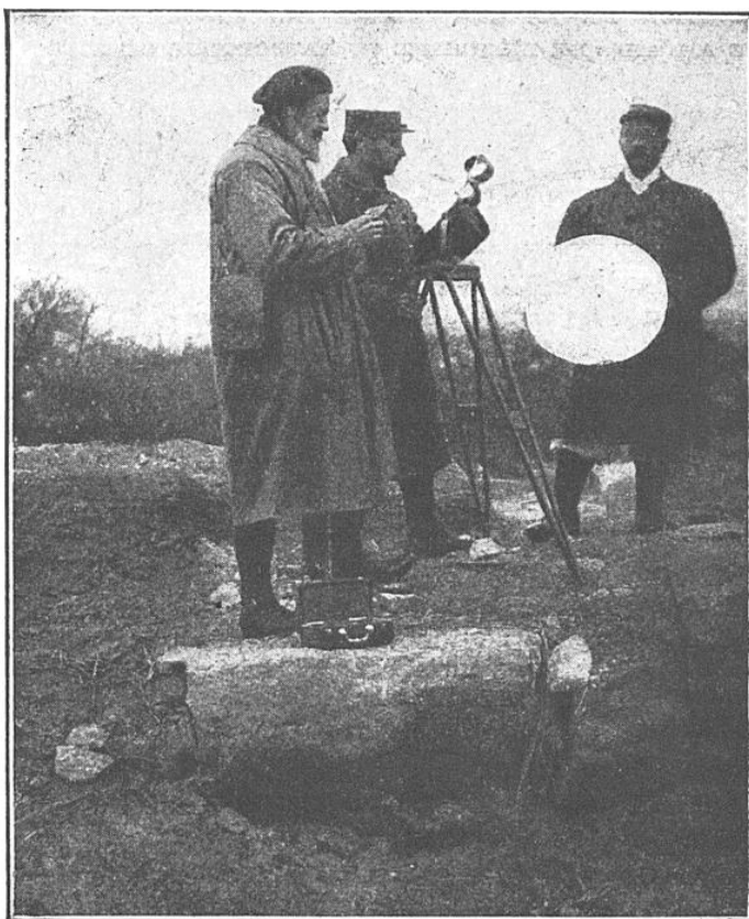
ON PEUT ENCORE DÉTERMINER LA DIRECTION DES VENTS PAR LA MARCHÉ DES NUAGES, AU MOYEN DE L'ÉQUERRE OU RAPPORTEUR CÉLESTE
