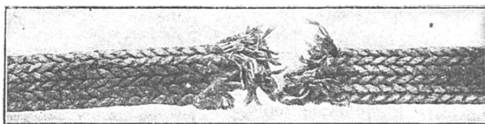
CABLE D'ALOËS ROMPU PAR LA MACHINE BUCKTON La rupture a eu lieu sous une charge de 30.000 kilos.
