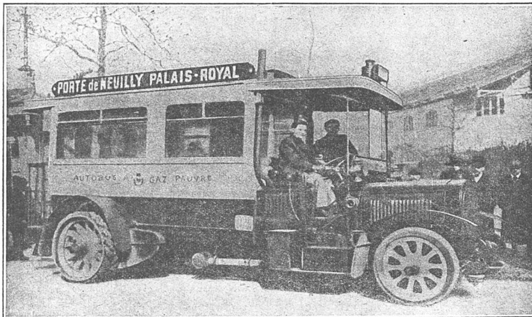
AUTOBUS A GAZ PAUVRE DE 40 CHEVAUX, MARCHANT A 40 KILOMÈTRES A L'HEURE
