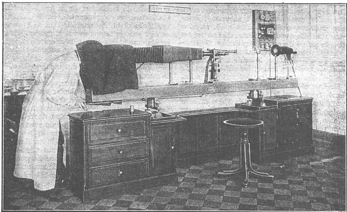
BANC MÉTALLOGRAPHIQUE IMAGINÉ PAR M. H. LE CHATELIER, MEMBRE DE L'INSTITUT Le microscope est monté sur un banc métallique et sa plate-forme reçoit l'échantillon à examiner.
