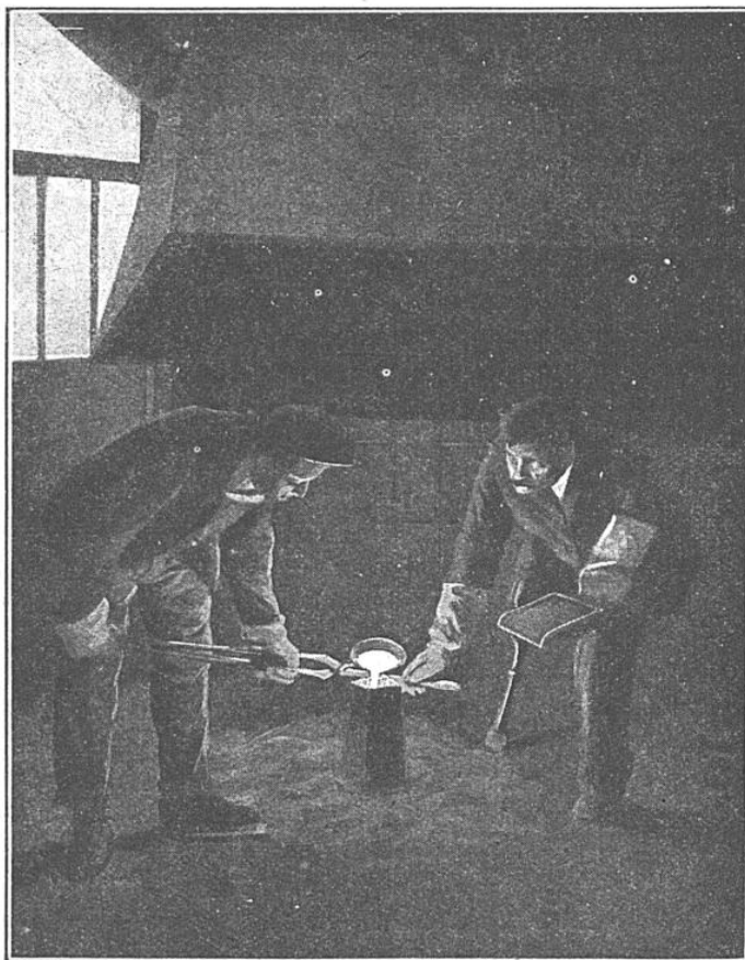
UNE COULÉE DE FERRO-CÉRIUM
