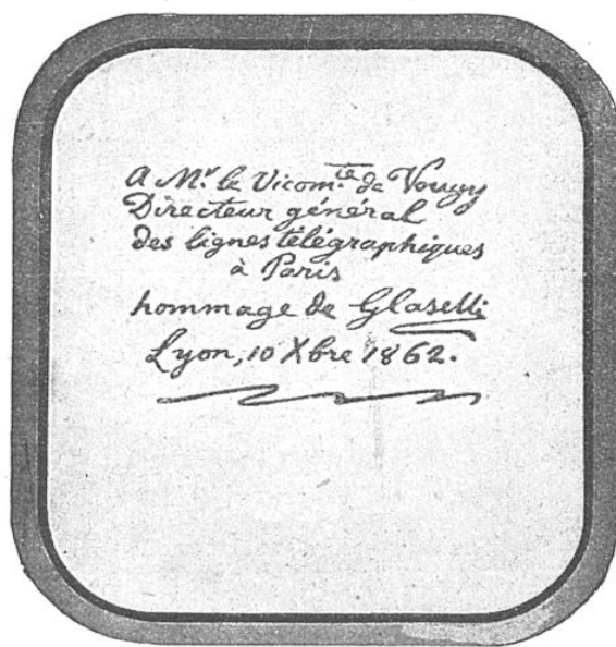
FIG. 2. — PREMIÈRE DÉPÊCHE OFFICIELLE TRANSMISE DE LYON A PARIS, PAR LE PANTÉLÉGRAPHE IMAGINÉ PAR L'ABBÉ CASELLI
