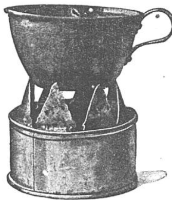
FIG. 11. — LA MÊME BOÎTE AVEC LES POINTES DÉCOUPÉES RELEVÉES ET SERVANT DE SUPPORT
