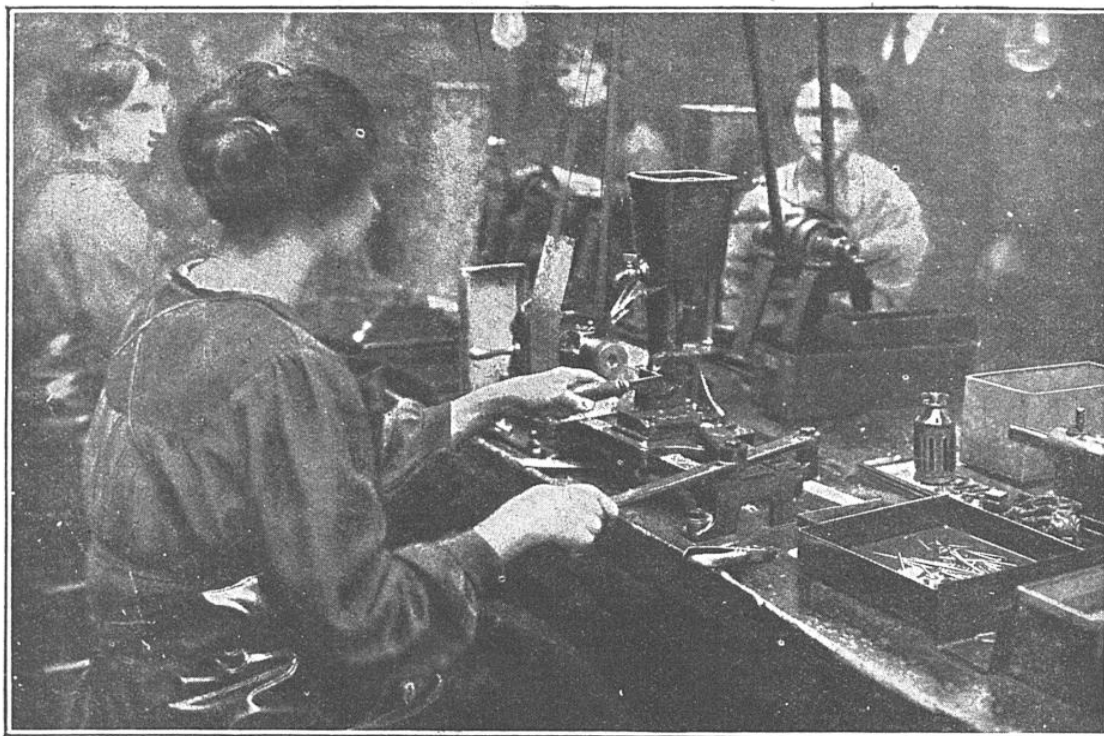
ICI, LES OUVRIÈRES PROCÈDENT AU FRAISAGE DES BAGUETTES DE FERRO-CÉRIUM ET À LEUR DIVISION EN PIERRES À BRIQUETS
