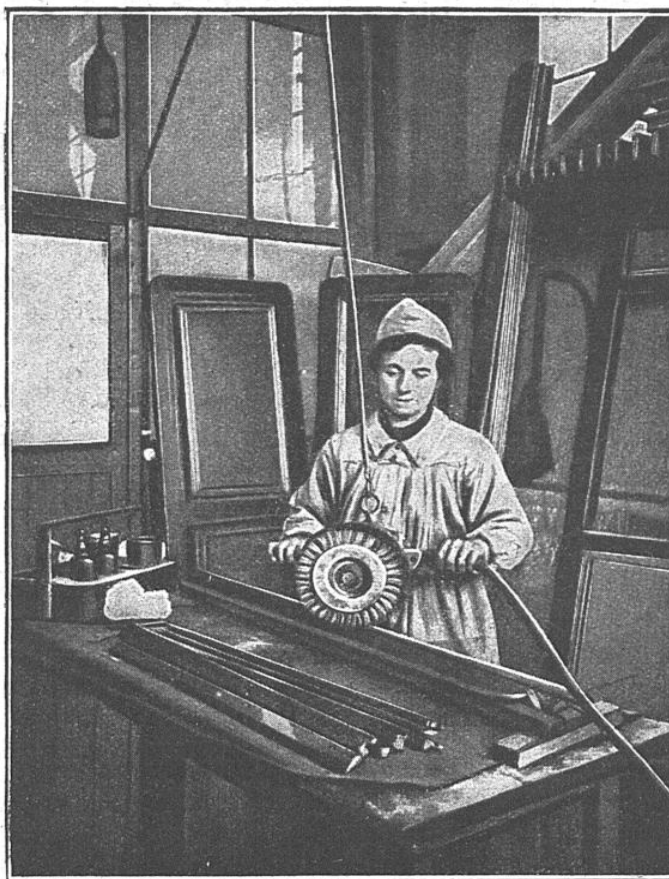
NETTOYAGE DES CHASSIS A LA BROSSÉ ÉLECTRIQUE DANS LES ATELIERS DE LA COMPAGNIE D'ORLÉANS
