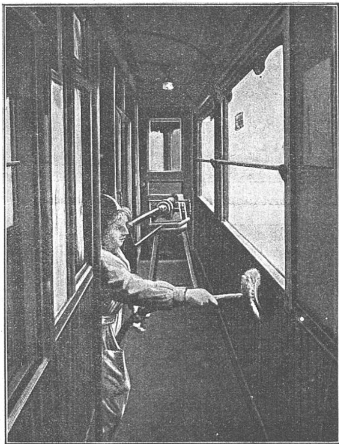
NETTOYAGE D'UN WAGON-COULOIR AVEC LA BROSSE ÉLECTRIQUE MONTÉE SUR CHARIOT
