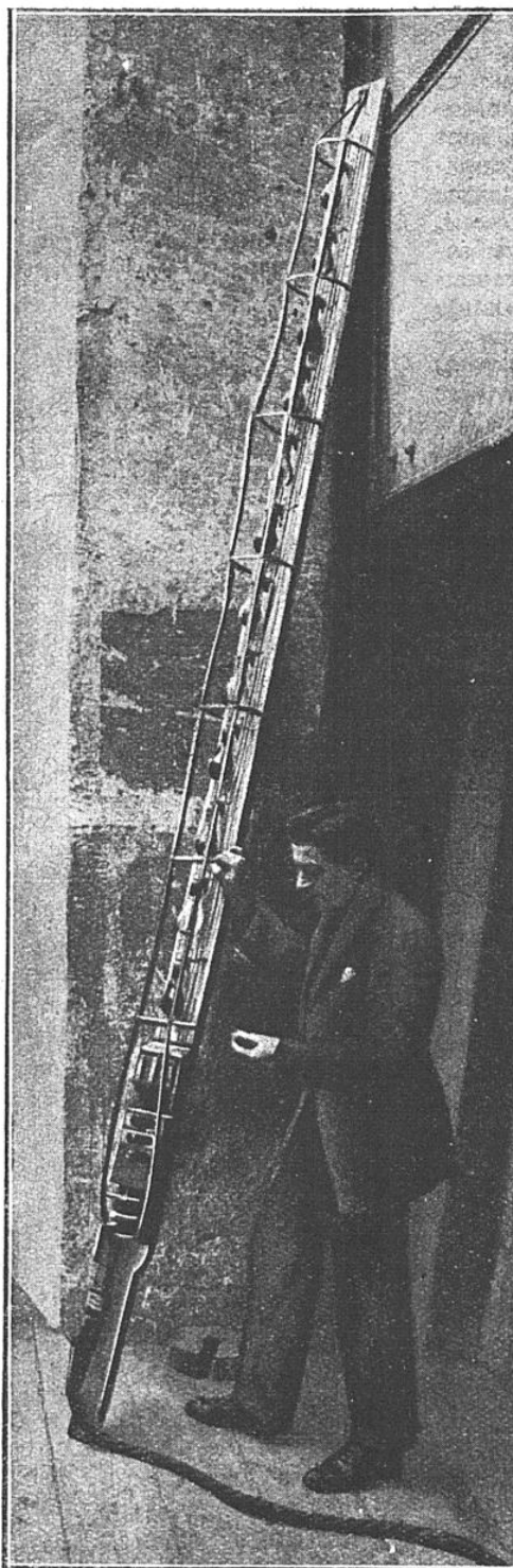
PORTANT MOBILE A DOUZE LAMPES On l'utilise soit verticalement, soit horizontalement sur le plancher même.
