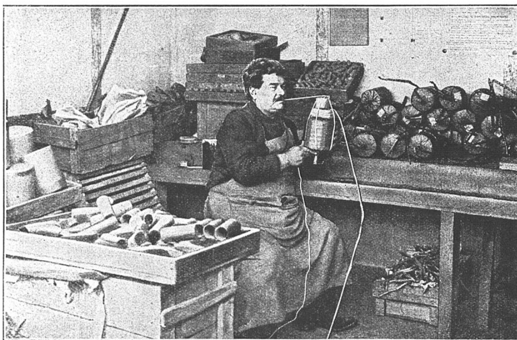
OUVRIER PROCÉDANT AU MONTAGE D'UNE GROSSE BOMBE A PARACHUTE
