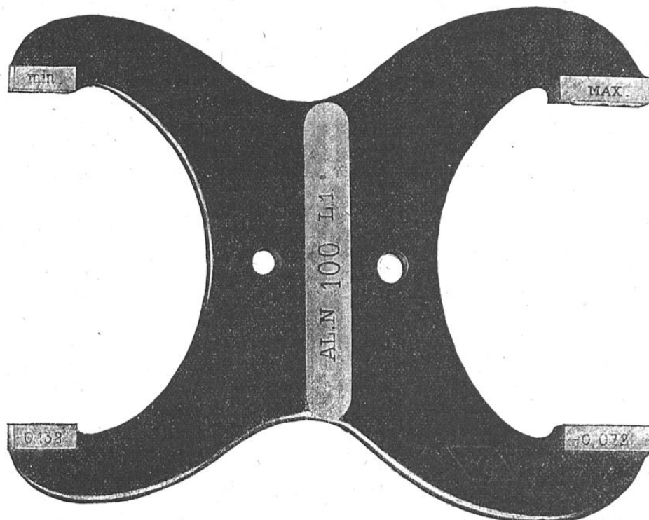
CALIBRE MACHOIRE DOUBLE DE 100 \frac{1}{2} POUR AJUSTAGE LIBRE
