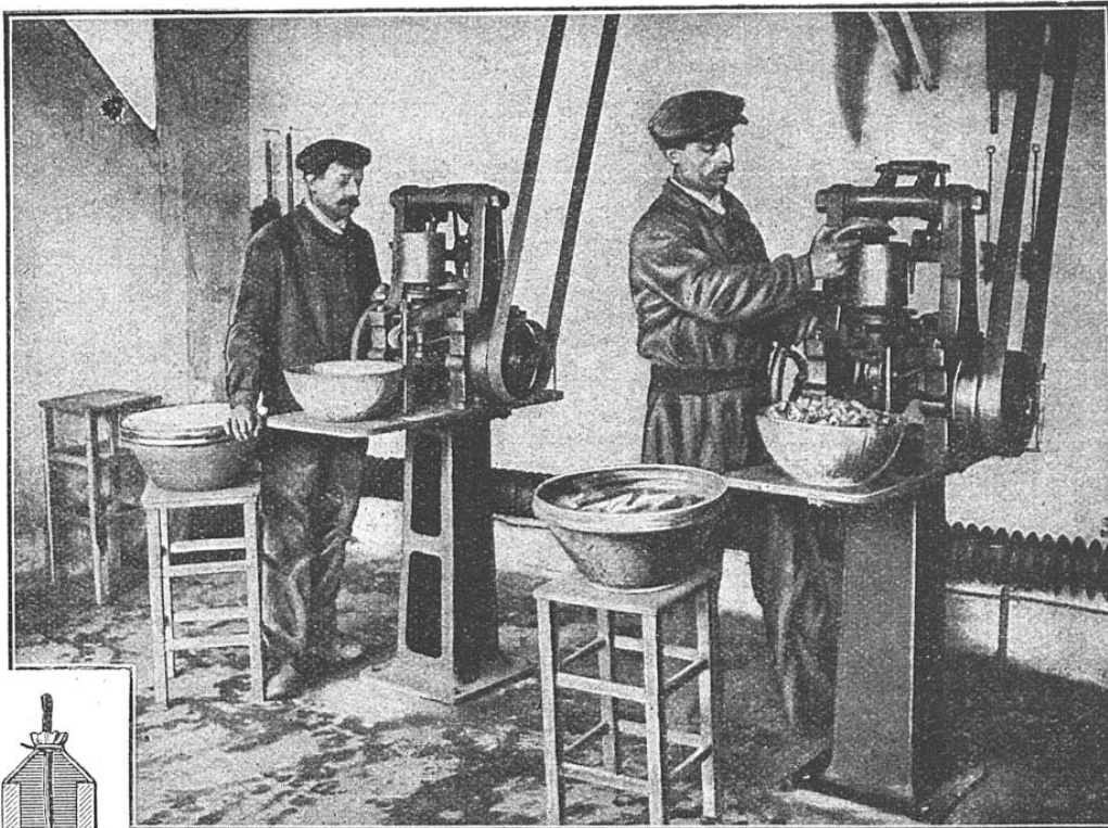
ATELIER DE FABRICATION DES « ÉTOILES » BLANCHES ET COLORÉES La poudre, préparée à l'avance, est versée dans la machine qui la comprime assez fortement et la livre en petits cubes représentant chacun une étoile.
