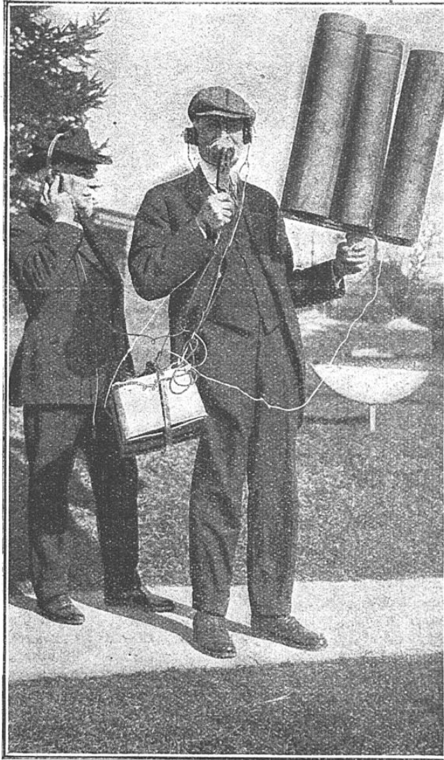
CONVERSATION RADIOTÉLÉPHONIQUE FAITE EN MARCHANT M. Mac Farlane, de Philadelphie, a combiné un poste radiotéléphonique portable qui, constitué surtout par un audion à la fois transmetteur, récepteur et amplificateur, se loge dans une seule boîte. L'antenne, portable, est faite de trois cylindres de cuivre.
