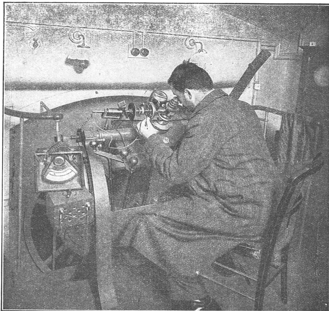
OBSERVATION A L'AIDE DU PHOTOMÈTRE STELLAIRE NORDMANN
