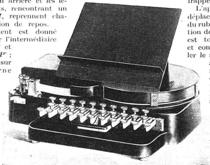
PERFORATEUR ÉLECTRO-MÉCANIQUE, SYSTÈME MORKRUM Dans cet appareil, les perforations sont effectuées au moyen de cinq poinçons actionnés à l'aide d'un seul électro-aimant.
