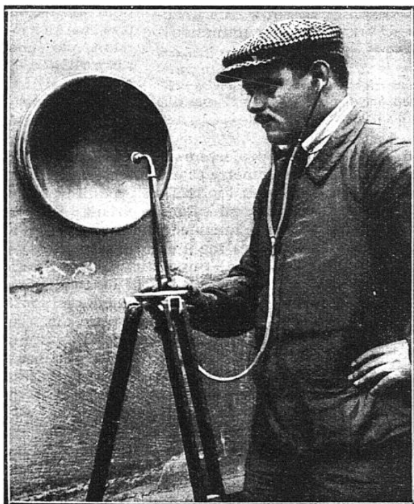
LA CAPSULE A NOIR DE FUMÉE PERMET LA RÉCEPTION DIRECTE PAR TUBE ACOUSTIQUE
