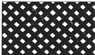
FIGURE 1 TRAME QUADRILLÉE ORDIN. (Grossie environ 20 fois) Elle est exclusivement utilisée pour l'image bleue.
