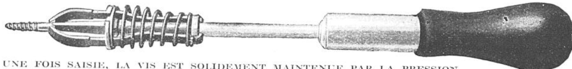
UNE FOIS SAISIE, LA VIS EST SOLIDEMENT MAINTENUE PAR LA PRESSION DES MACHOIRES ; ON PEUT AINSI LA VISSER ET DÉVISSER SANS REPRISSES
