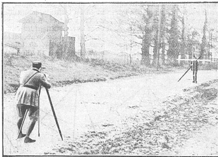
OFFICIER TOPOGRAPHE OPÉRANT AU TACHÉOMÈTRE L'instrument, monté sur trépied, est placé en un point connu ; l'opérateur vise la mire que tient au loin son aide.
