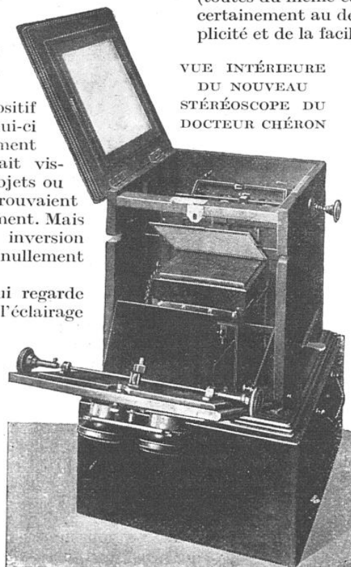
A part les deux glaces à 45° et la nouvelle position du verre dépoli, l'appareil ne se différencie pas d'un stéréoscope classeur ordinaire.
