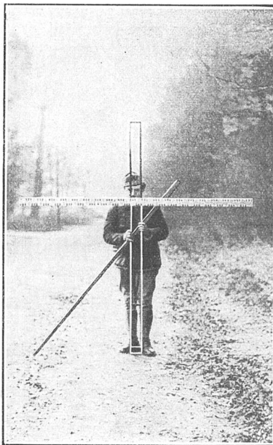
L'AIDE OPÉRATEUR EST EN PLACE, TENANT LA MIRE DU TACHÉOMÈTRE, DITE EUTHYMÈTRE. A l'aide de la tige de bois, placée en travers et appuyée au sol, l'aide assure la stabilité horizontale de la mire.
