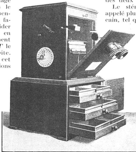
FIG. 7.— AUTRE STÉRÉOSCOPE A COURT FOYER
