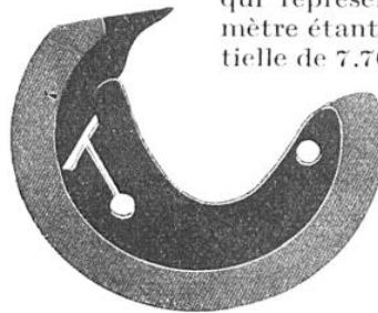
FRAGMENT PRÉLEVÉ À LA PÉRIPHÉRIE D'UNE SCIE CIRCULAIRE À DENTS RAPPORTÉES DU SYSTÈME ATKINS
