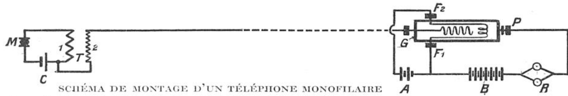
SCHÉMA DE MONTAGE D'UN TÉLÉPHONE MONOFILAIRE
