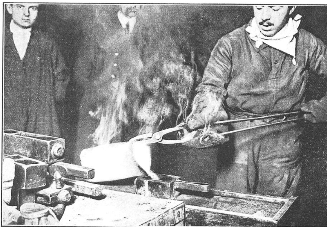
LE COULAGE EN LINGOTIÈRE DE LA MASSE MÉTALLIQUE FONDUE
