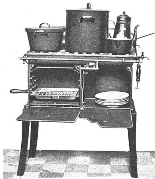
GRAND MODÈLE DU FOURNEAU A RÉCUPÉRATION D'AIR CHAUD FONCTIONNANT AU GAZ L'appareil est muni d'un bain-marie dont l'eau, ainsi d'ailleurs que le chauffe-plat et tous les récipients posés sur le dessus du fourneau, est chauffée par un brûleur unique. Ce dernier consomme moins de gaz qu'un seul des brûleurs multiples de l'appareil du type ordinaire.
