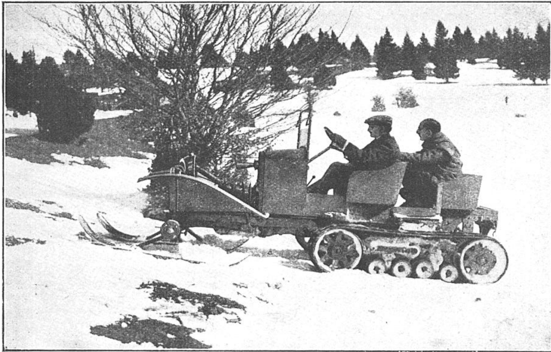
LES ROUES AVANT DU VÉHICULE ONT COMPLÈTEMENT DISPARU ; ELLES ONT ÉTÉ REMPLACÉES PAR DE LARGES SKIS MÉTALLIQUES QUI GLISSENT SUR LA NEIGE
