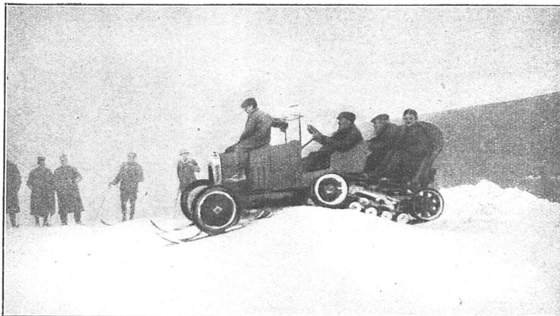
LA VOITURE, MUNIE DE LA CHENILLE SOUPLE, FRANCHIT UN MONTICULE DE NEIGE
