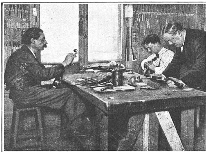
POSE DE LA TOUCHE ET DES CHEVILLES
