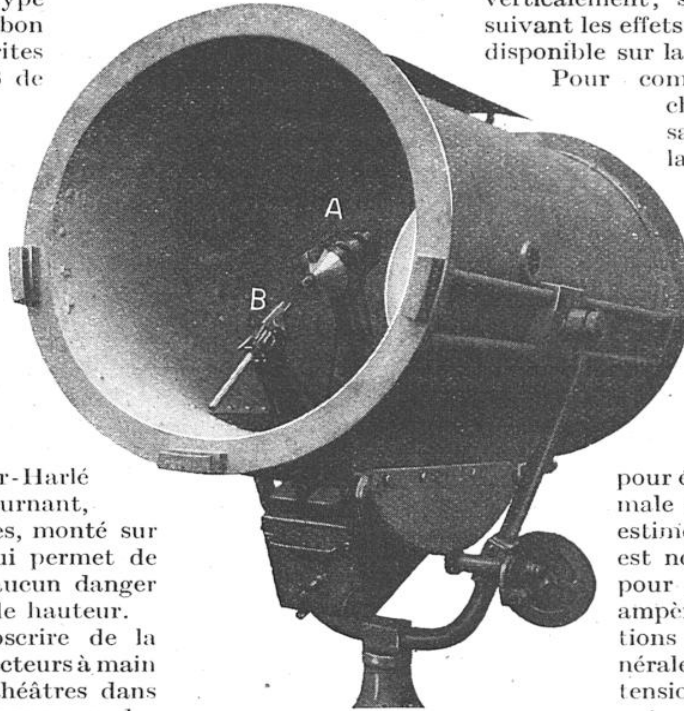
FIG. 7. — PROJECTEUR SAUTTER-HARLÉ MONTÉ SUR PIED MOBILE. Cet appareil est vu de l'arrière, le miroir enlevé. On voit au fond le charbon positif A qui, outre son mouvement d'avancement, tourne constamment sur lui-même. Le dispositif conique visible autour du charbon sert au refroidissement. En avant se trouve le charbon négatif B, simplement muni d'un dispositif d'avancement.
