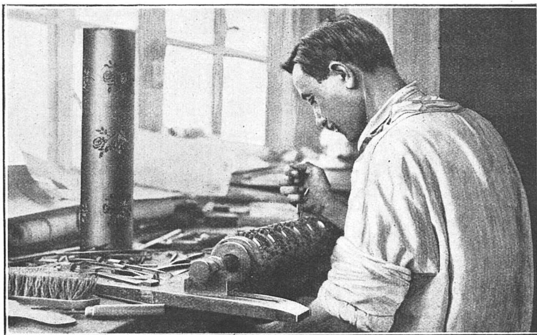
ON VOIT ICI UN OUVRIER OCCUPÉ À GARNIR UN ROULEAU D'IMPRESSION
