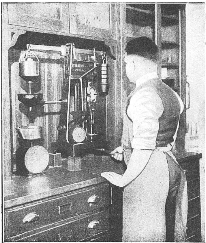
ICI, L'ON MESURE EXACTEMENT LA CAPACITÉ DE LIAISON DU CIMENT AU MOYEN D'ÉPROUVETTES
