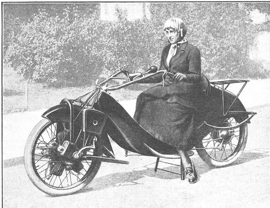
VUE D'ENSEMBLE DU MOTOCYCLE « MEGOLA », MUNI D'UNE NOUVELLE ROUE MOTRICE ET DIRECTRICE A L'AVANT ET POURVU D'UNE CARROSSERIE ÉLÉGANTE ET PRATIQUE
