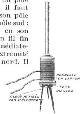
FIG. 2 BIS. — DÉTAILS DU CLOU TRANSFORMÉ EN UN PETIT ÉLECTRO-AIMANT
