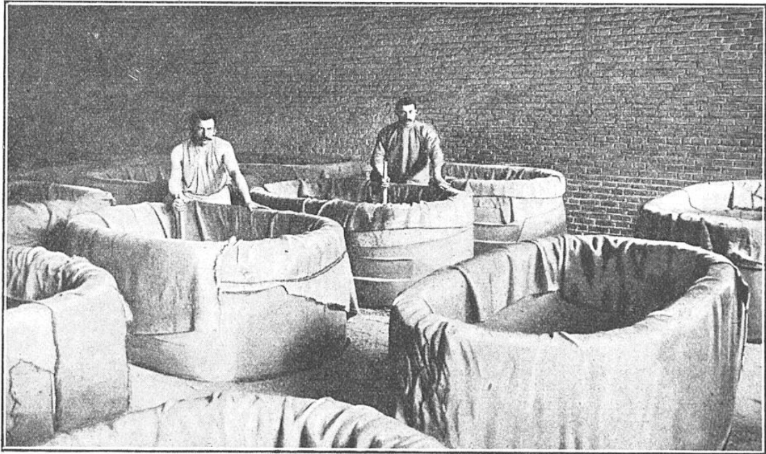
LA CONFECTION DES « POTS » SERVANT DE CREUSETS DANS LA FABRICATION DES GLACES
