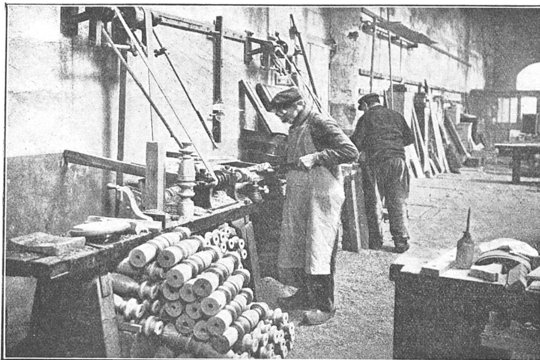
DANS UN COIN D'ATELIER, DES OUVRIERS TOURNENT DES PIEDS DE TABLE
