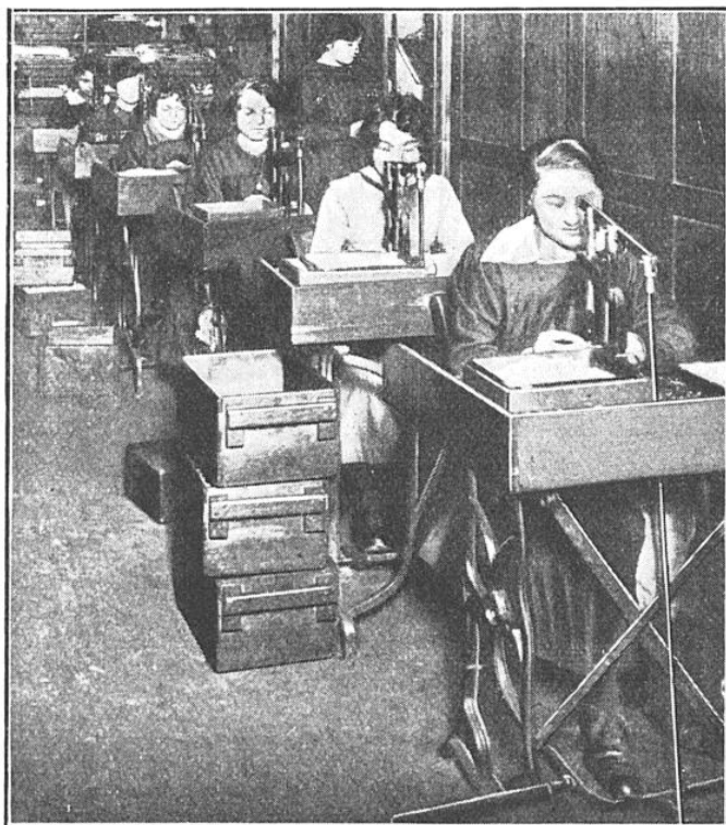
MISE EN PLACE, DANS LE FOND DU BOUCHON DU TUBE, D'UNE PETITE RONDELLE DE LIÈGE
