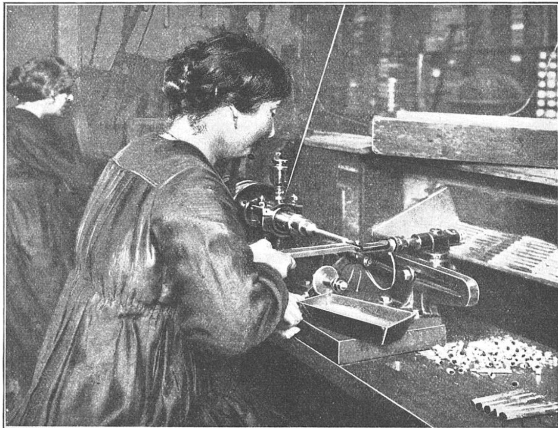
LE FILETAGE SUR LE TOUR DE LA TÊTE OU GOULOT DU TUBE D'ÉTAIN
