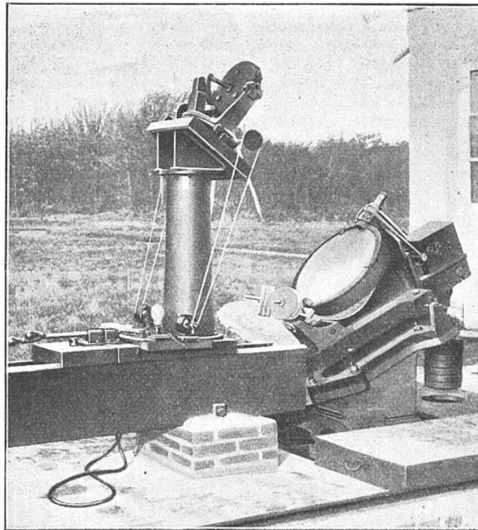
COELOSTAT A DEUX MIROIRS DE L'OBSERVATOIRE D'ASTRONOMIE PHYSIQUE DE MEUDON
