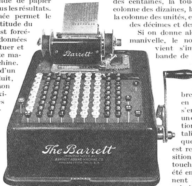
VUE EXTÉRIEURE DE LA MACHINE A CALCULER Les nombres sont inscrits sur la bande de papier visible en haut, au moyen des touches et de la manivelle.
