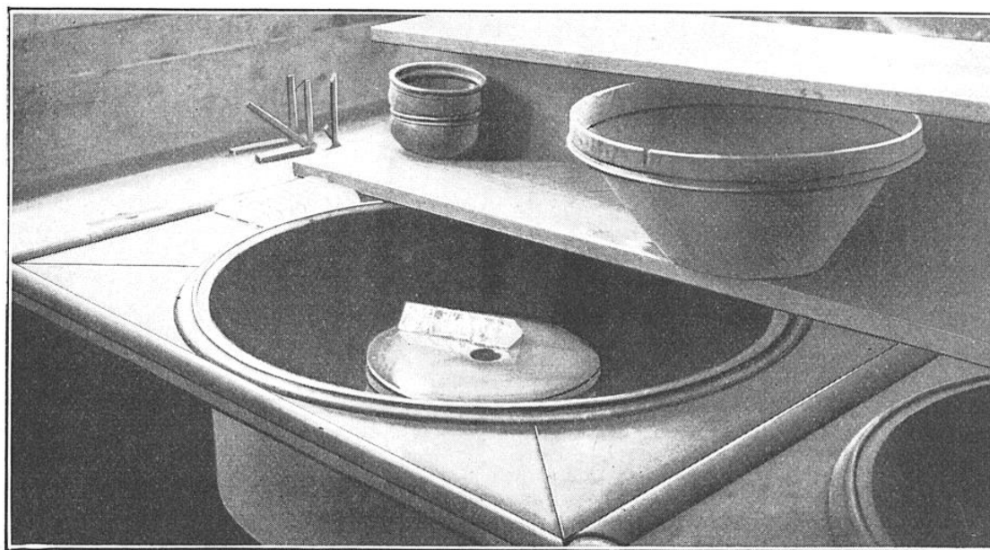
MACHINE A ÉBAUCHER LES PRISMES AU MOYEN DU GRÈS
