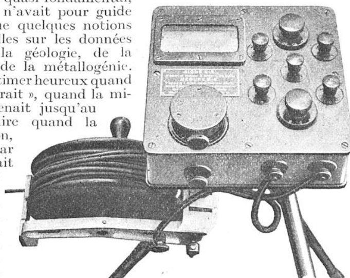
FIG. 1. — POTENTIOMÈTRE SCHLUMBERGER INSTALLÉ SUR SON PIED MÉTALLIQUE
