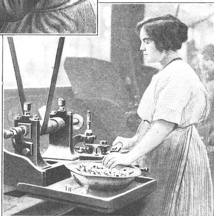
UNE PETITE SCIE CIRCULAIRE TOURNANT A TRÈS GRANDE VITESSE, DÉCOUPE DANS LES NOIX LE LOGEMENT DES BRANCHES DU PARAPLUIE
