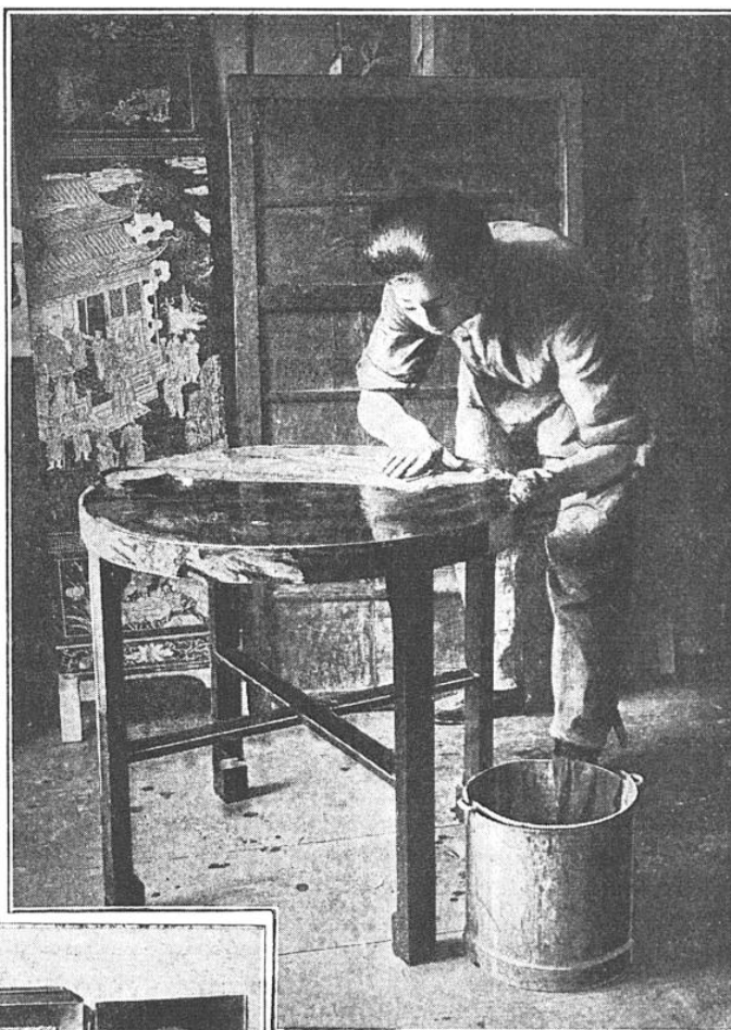
FIG. 11. — POLISSAGE D'UNE TABLE DE LAQUE ROUGE, IMITATION DE LAQUE DE PÉKIN
