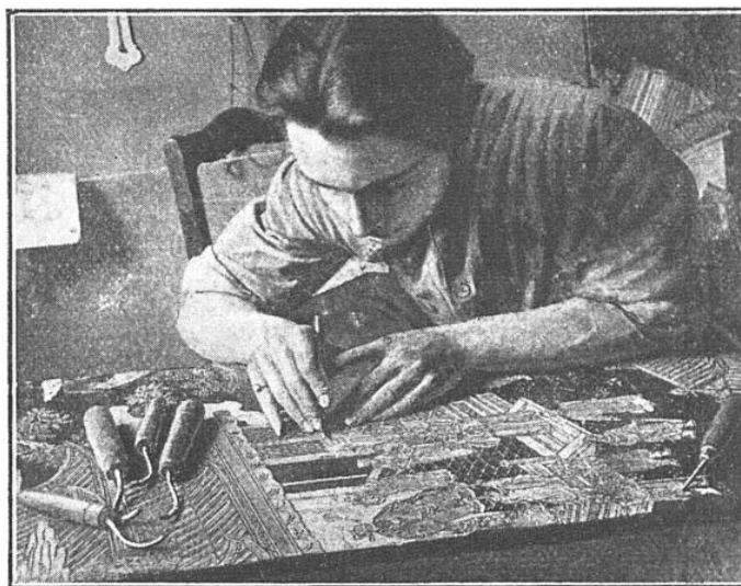
FIG. 4. — LA GRAVURE DU COROMANDEL L'artiste creuse la laque avec un burin en ménageant des filets qui constituent le dessin.
