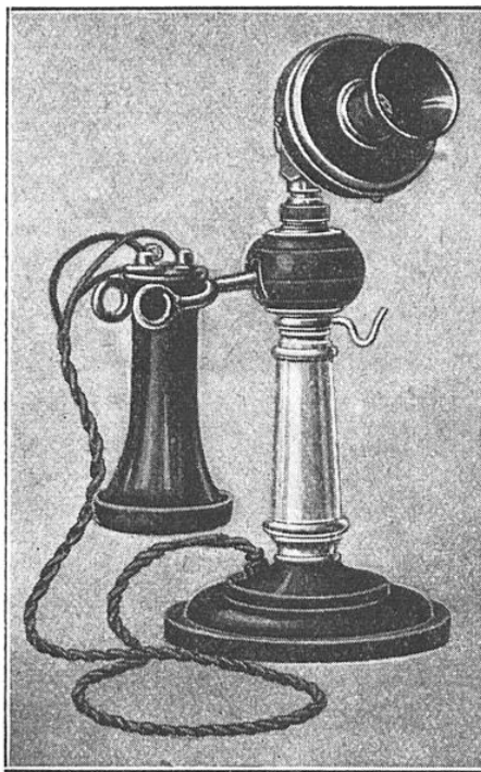
FIG. 15. — POSTE MOBILE DU « MATÉRIEL TÉLÉPHONIQUE » ÉQUIPÉ AVEC UN MICROPHONE « SOLID-BACK » ET UN RÉCEPTEUR TYPE BELL
