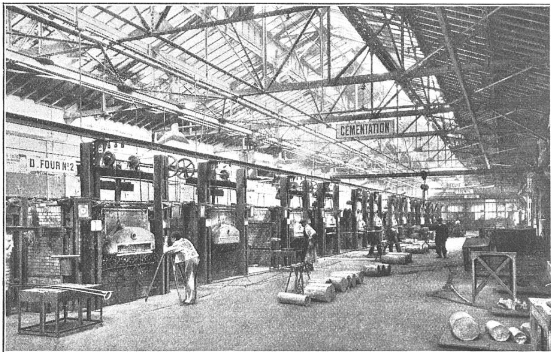
SALLE DES FOURS POUR LE TRAITEMENT THERMIQUE DES PIÈCES DE MÉCANIQUE
