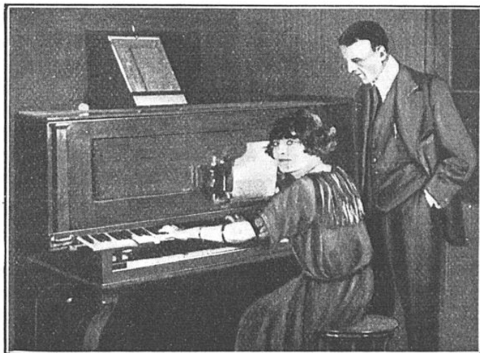
EN JOUANT SUR LE SECOND CLAVIER, ON INSCRIT LA MUSIQUE SUR LA FEUILLE DE PAPIER MOBILE
