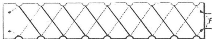
FIG. 4. — CELLULE DE SÉLÉNIUM EXTRA-SENSIBLE AVEC ENROULEMENT ORDINAIRE (L. ANCEL) F, fils d'amenée et de sortie du courant.
