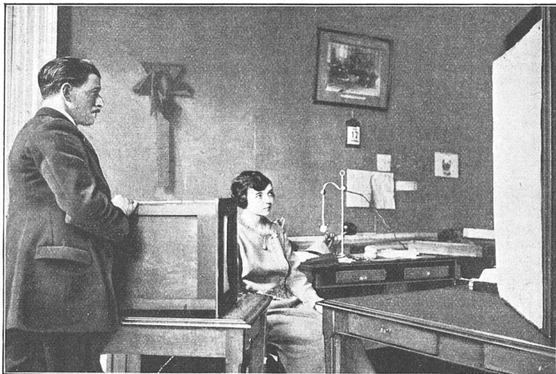
EN PLACANT LA MACHINE A LIRE HORIZONTALEMENT ET EN RETIRANT LA VITRE DÉPOLÉE, L'IMAGE SE PROJETTE AU LOIN SUR LE MUR OU SUR UN ÉCRAN
