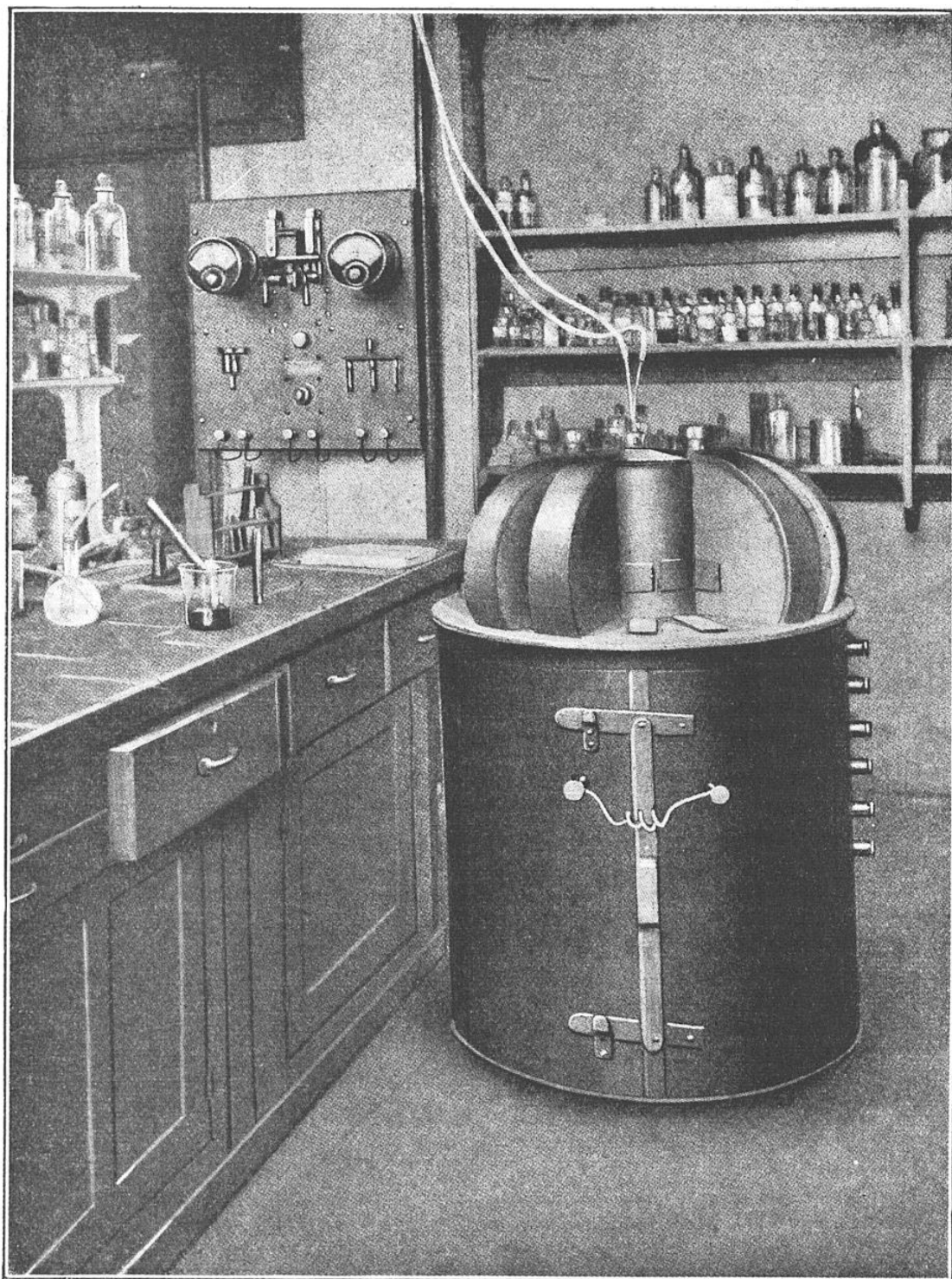
APPAREIL A DIFFRACTION DESTINÉ A DÉTERMINER LA COMPOSITION ATOMIQUE DES CORPS LES PLUS DIVERS AU MOYEN DES RAYONS X
