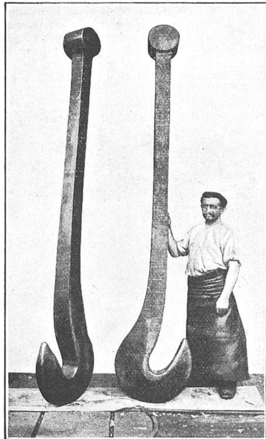
DEUX CROCHETS SIMPLES DE LEVAGE POUR TREUILS DE 60 TONNES
