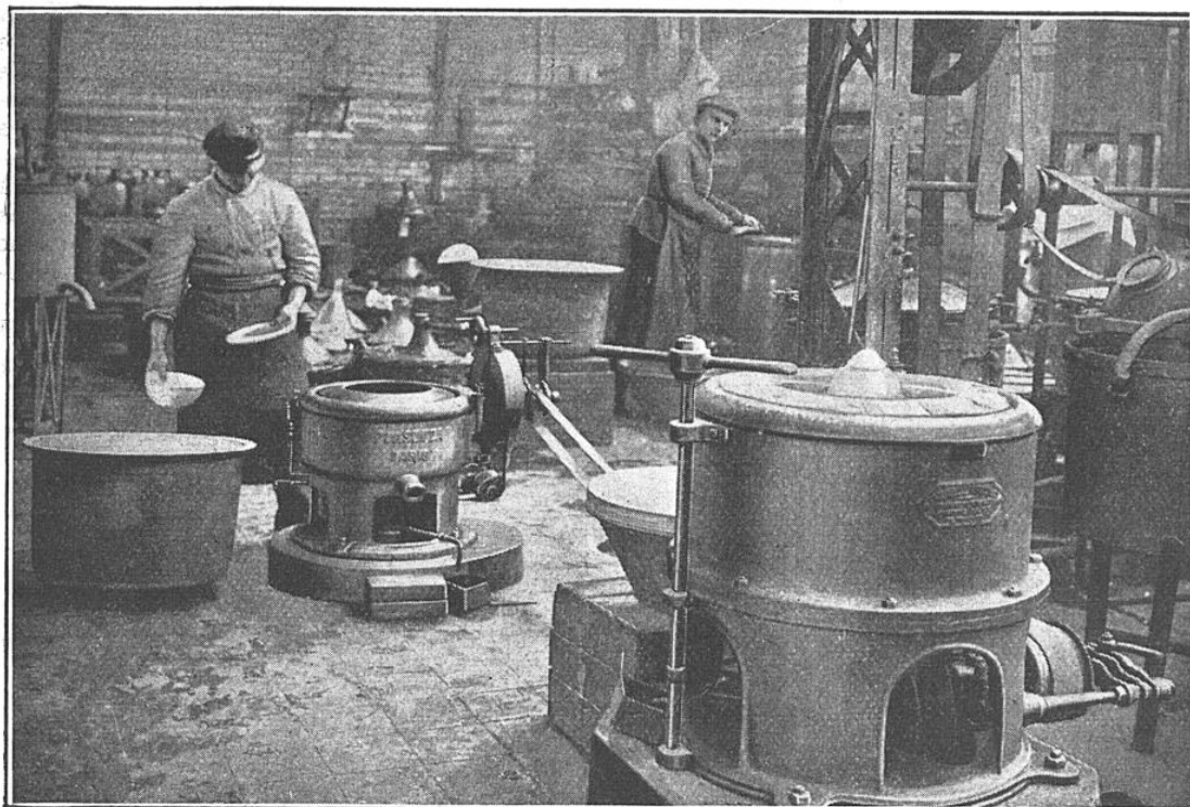
APRÈS LE BENZOYLAGE ET LA CRISTALLISATION DANS L'ALCOOL, LA STOVAÏNE EST ESSORÉE A LA TURBINE, PUIS SÉCHÉE A L'ÉTUVE ET TAMISÉE
