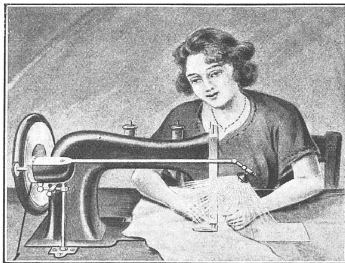
GRACE A UNE PETITE MAGNÉTO ACTIONNÉE PAR LE VOLANT DE LA MACHINE A COUDRE ET ALIMENTANT UNE PETITE LAMPE ORIENTABLE, ON PEUT, LE SOIR VENU, TRAVAILLER AVEC AUTANT DE FACILITÉ QU'EN PLEIN JOUR
