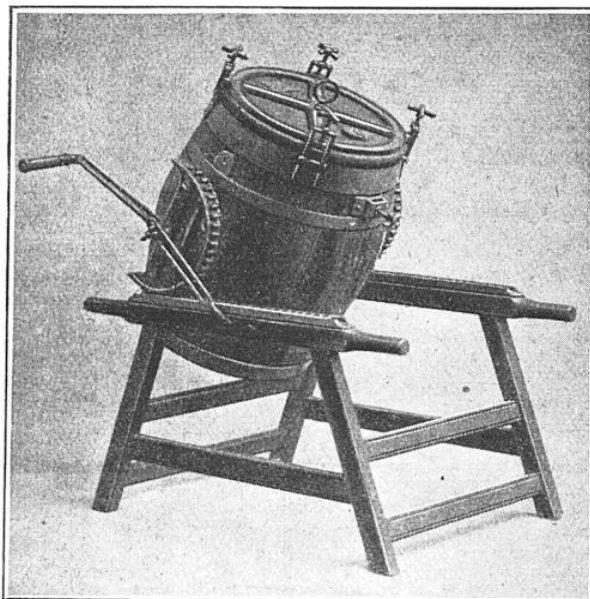
FIG. 2. — MÉCANIQUE DE BALANCEMENT DE LA CUVE DE LA MACHINE À LAVER « SAMO »
