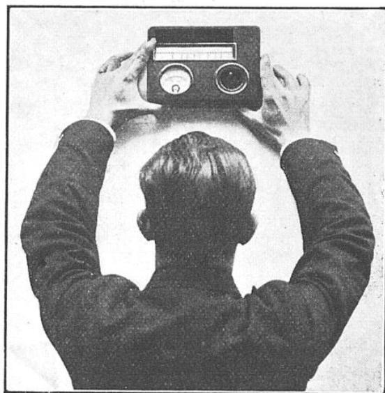
FIG. 4. — MESURE D'ÉCLAIREMENT SUR UN MUR (APPAREIL VERTICAL)
