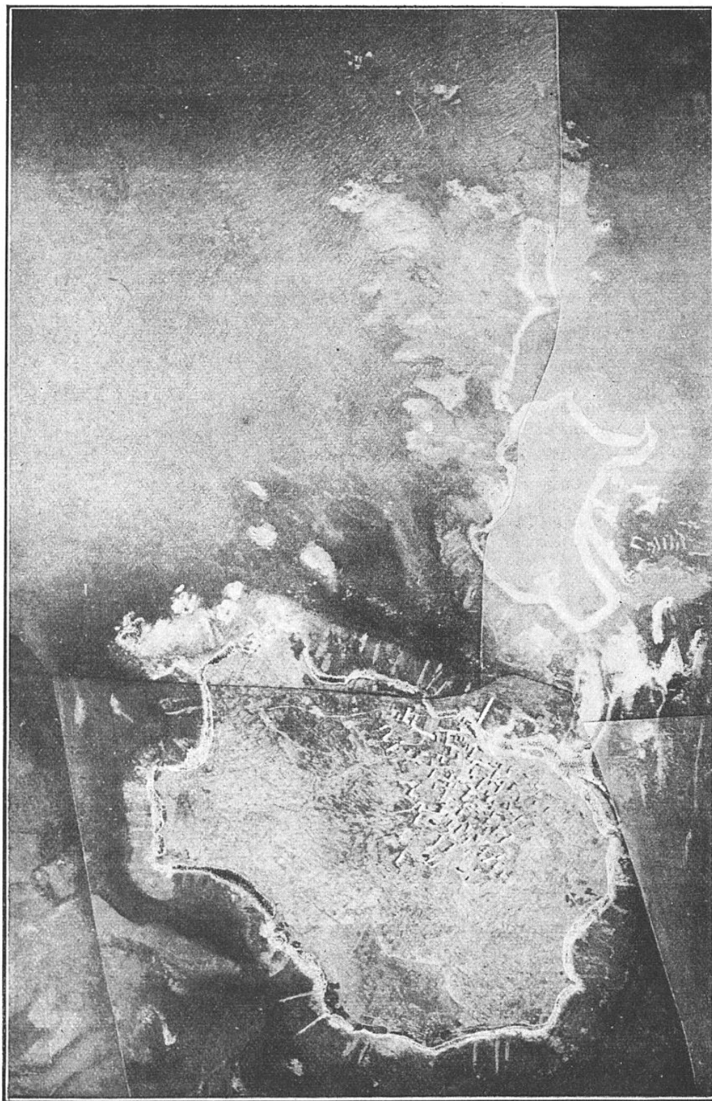
L'ÎLE DE MOLÈNE, A L'ENTRÉE DE BREST, ET LES ÉCUEILS SOUS-MARINS QUI L'ENTOURENT On distingue nettement l'assemblage des quatre épreuves des clichés photographiques pris par l'hydravion volant à 2.500 mètres d'altitude environ.
