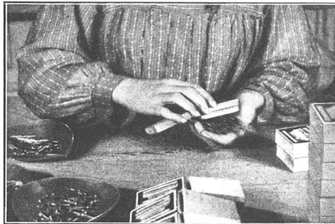
L'EMBOITEUSE POSSÈDE UNE RARE DEXTÉRITÉ Elle vide dans sa main la grosse de plumes et les agite de façon à les disposer toutes parallèlement, les becs du même côté.
