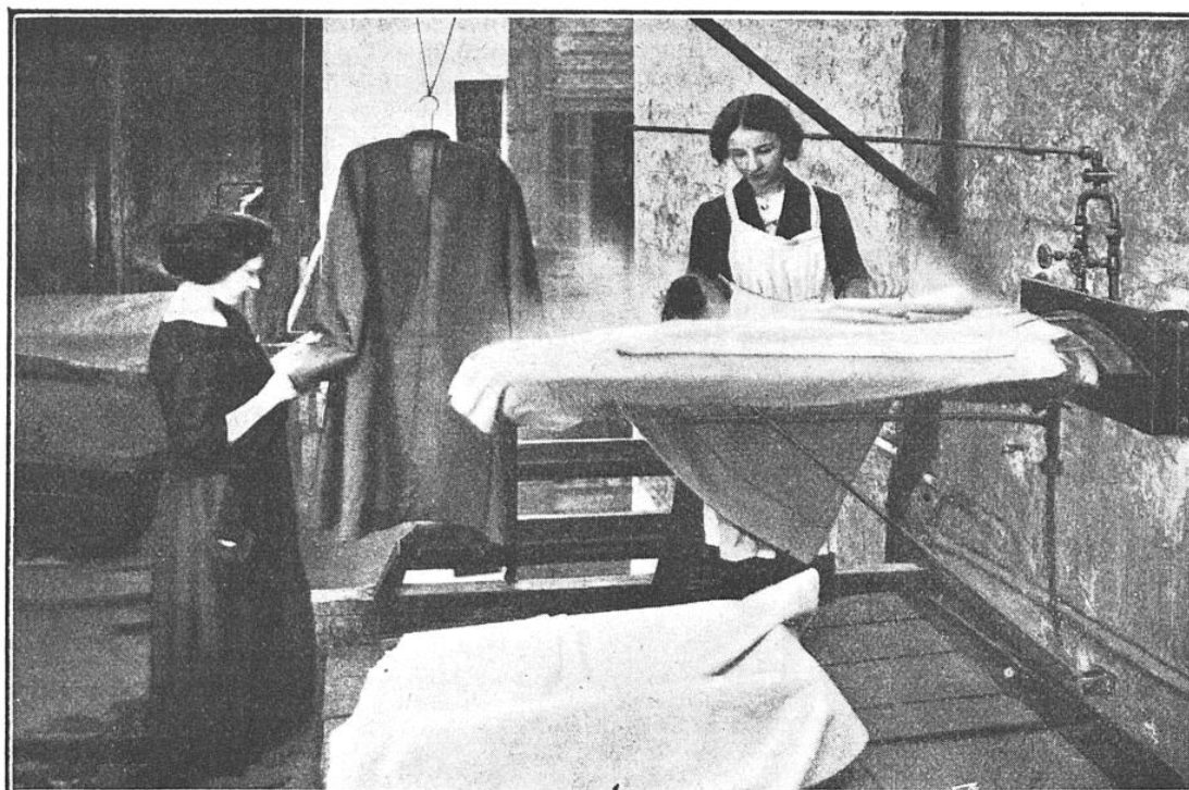
LE REPASSAGE SUR LA TABLE A VAPEUR « PLATINEUSE »
