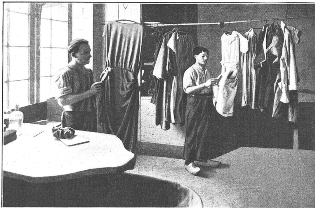
DÉTACHAGE A SEC A LA BROUSSE, AVEC DE LA BENZINE
