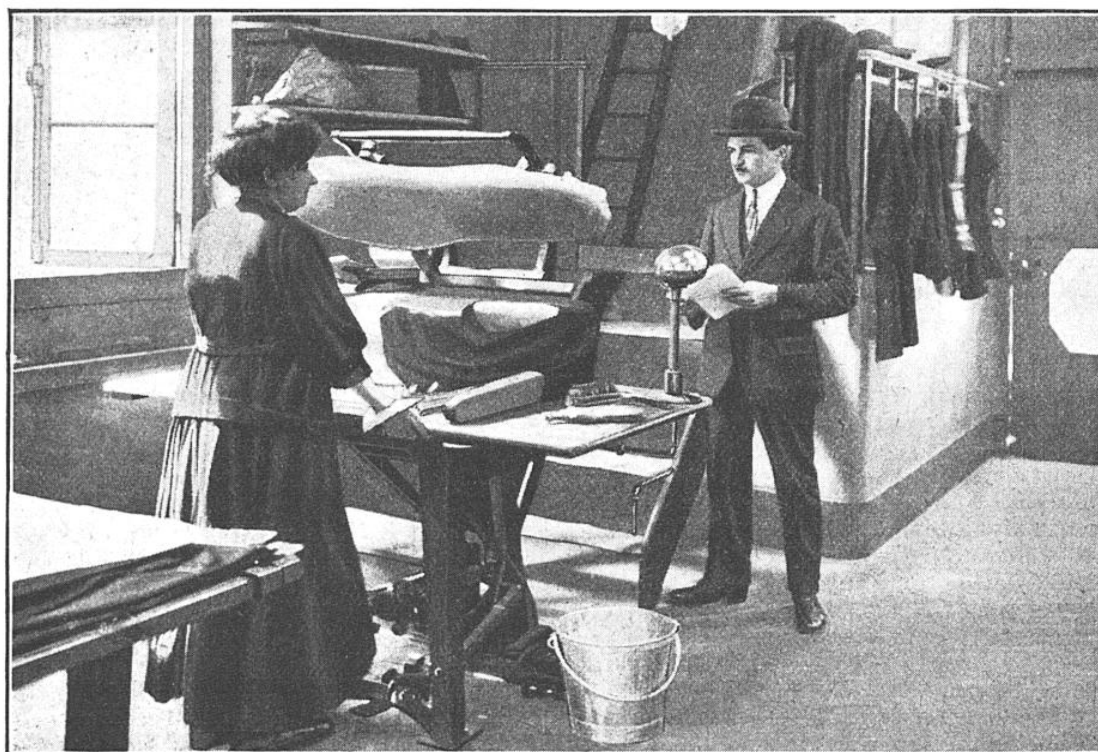
MACHINE AMÉRICAINE POUR LE REPASSAGE RAPIDE DES VÊTEMENTS DRAPÉS
