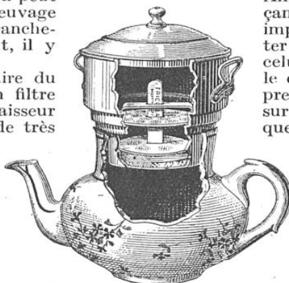
FIG. 1. — CAFETIÈRE DOMESTIQUE MUNIE DU FILTRE "TRICOLATOR"
